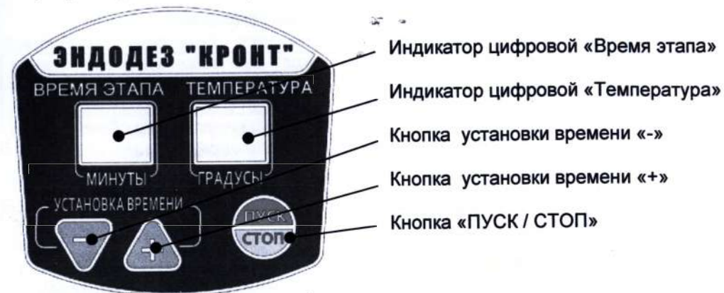
Рис.19 Панель управления блока питания и управления
